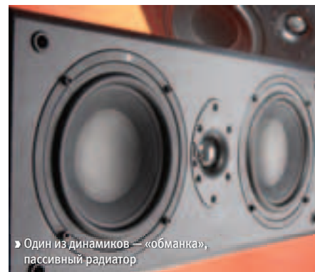
► Высокочастотник расположен по схеме d'Appolito
