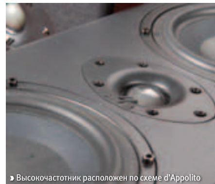
► Высокочастотник расположен по схеме d'Appolito
